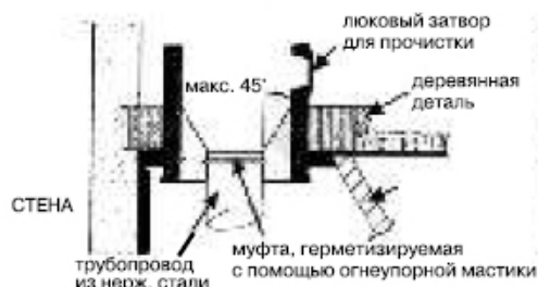
ПРАВИЛЬНО рис. CD4 Стыковка трубопровода с дымоходом не выходит за пределы муфты; раструбное соединение, мин. 40 мм
