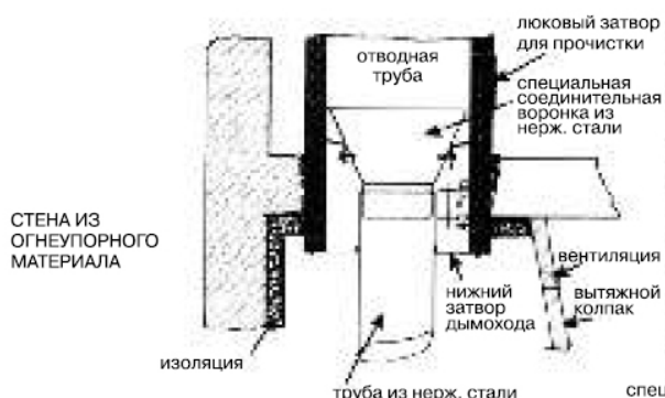
ПРАВИЛЬНО рис. CD5 Стыковка осуществляется с помощью спец. детали внутри дымохода; раструбное соединение дл. мин. 40 мм внутри металл. трубы
