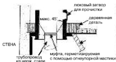
ПРАВИЛЬНО рис. CD4 Стыковка трубопровода с дымоходом не выходит за пределы муфты; раструбное соединение, мин. 40 мм
