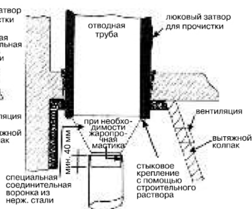
ПРАВИЛЬНО рис. CD6 Стыковка осуществляется с помощью спец. детали под дымоходом; раструбное соединение дл. мин. 40 мм внутри металл. трубы
